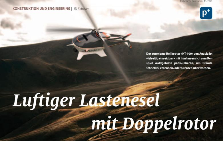
Autonome Fluggeräte sind stark im Trend, viele Projekte allerdings noch im Prototypenstadium. Einen Schritt weiter und mitten in der Zulassung ist die Schweizer Anavia mit ihrem autonomen Helikopter «HT-100». Das neuartige Gerät mit 65 Kilo Zuladung wurde mit Unterstützung von Inneo komplett in «Creo» entwickelt.
