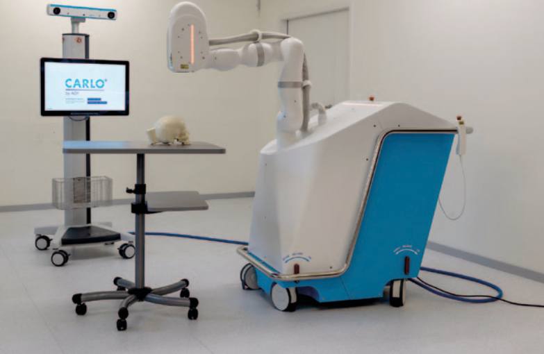
«Carlo», der weltweit erste Roboter, der Knochen per Laser schneidet, wurde mit der 3D-CAD-Software «Creo» entworfen. (Bild: Dante Simonitto)
