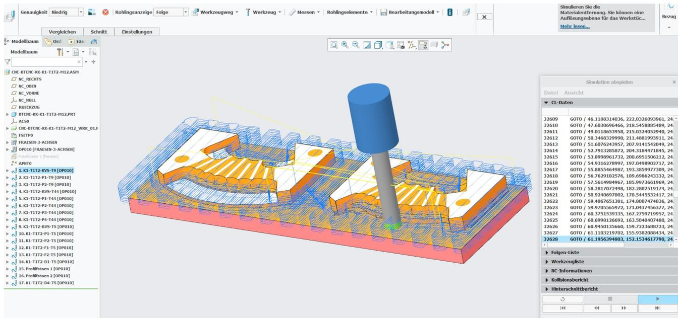
**Bild 1** Harke & Paulig entwickelt und produziert komplexe Gussteile. Entsprechend komplex sind die NC-Programme für die Sandgussformen. (Bild: Harke & Paulig)
