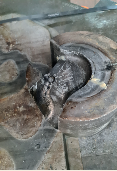
Bild 1. Nach tausenden von Druckgussvorgängen muss der Angussdom einer zur Revision angelieferten Form aufgearbeitet werden.
